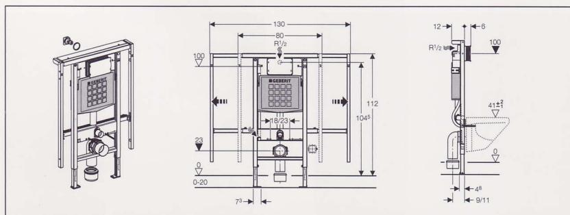
Duofix τηλεσκοπικό – εντοιχιζόμενο καζανάκι με στοιχείο στήριξης για κρεμαστή λεκάνη
