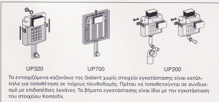
Τα εντοιχιζόμενα καζανάκια της Geberit χωρίς στοιχείο εγκατάστασης είναι κατάλληλα για τοποθέτηση σε τοίχους πλινθοδομής. Πρέπει να τοποθετούνται σε συνδυασμό με επιδαπέδιες λεκάνες. Τα βήματα εγκατάστασης είναι ίδια με την εγκατάσταση του στοιχείου Kombifix.
